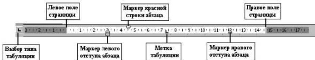
Рис. Горизонтальная линейка
